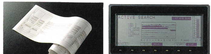
■アクティブサーチの結果を示すディスプレイ メモリーページに記憶されている7局の放送の有無、強度を一定時間ごとに調べ、その結果をグラフ化して表示します。 ■メモリーさせたすべての局を、ページごとの表に印字できるので、こうして印字しておけば、その表をみながら選局することもでき、便利に利用できます。
